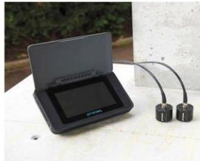
混凝土均勻性評估的線性掃描板載存儲及波形回放
