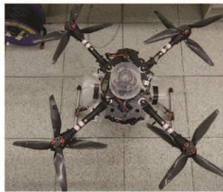
圖(五)我們用的四軸八旋翼機
